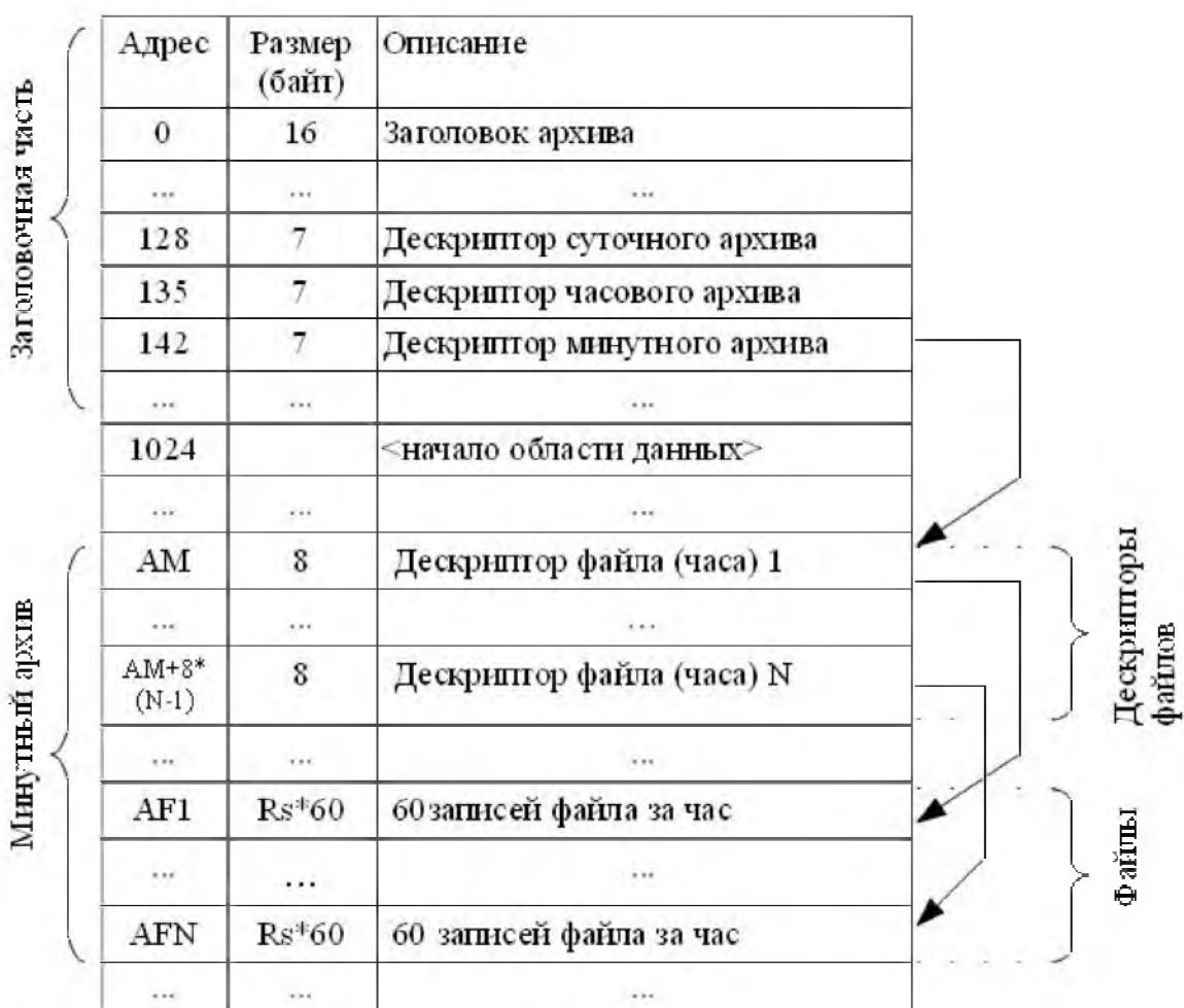
На этой схеме **AM** – адрес таблицы дескрипторов минутного архива, **N** – количество файлов минутного архива, **AF1...AFN** – адреса файлов, **Rs** – размер архивной записи (байт), **Rs\*60** – размер файла минутного архива за один час.
