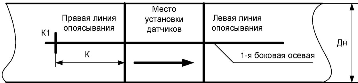
6.3.3. На трубопроводе, со стороны 2-й боковой осевой линии, отмеряется расстояние «К» от левой линии опоясывания налево, вдоль 2-й боковой осевой линии и отмечается вторая контрольная точка К2.
