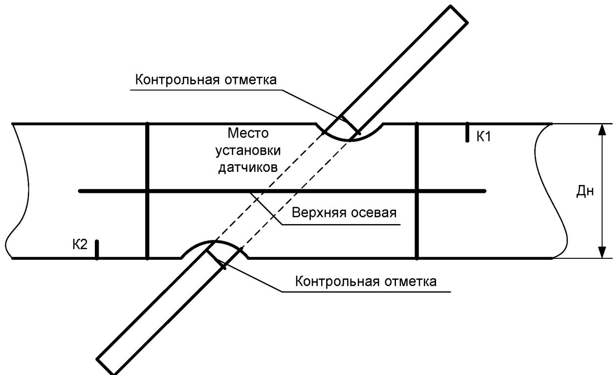
7.6. На шток надеваются присоединительные патрубки. Эллиптическая поверхность патрубка должна быть обращена к трубопроводу.
