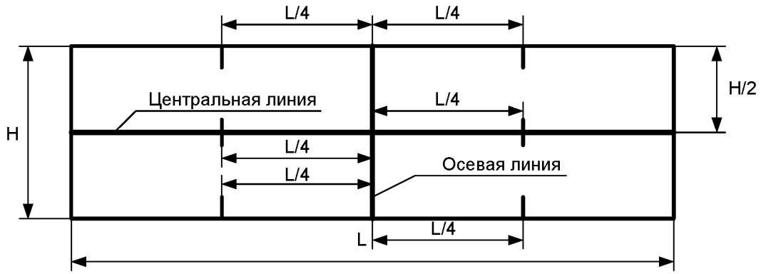
4.6.5. Через отмеченные точки по линейке проводятся линии горизонта. При дальнейшей разметке трубопровода эти линии пройдут строго в горизонтальной плоскости по диаметру трубопровода.
