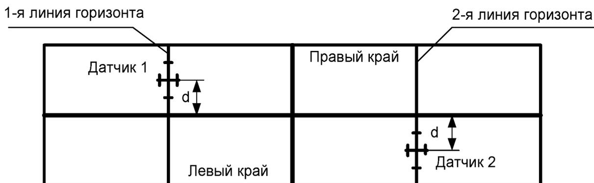
4.7.4. На отмеченные места шаблона своей эллиптической поверхностью устанавливаются соединительные патрубки. Вдоль эллиптической поверхности патрубка маркером очерчивается эллипс.
