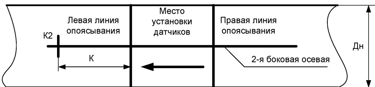
6.4. На трубопроводе производится разметка отверстий для установки врезных датчиков.
