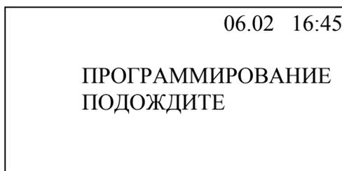
В режиме программирования прибор выполняет самонастройку в соответствии с текущими значениями параметров (диаметром трубопровода, толщиной стенки и т. п.). Режим программирования включается автоматически при включении прибора после режима диагно-
