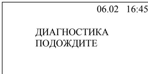
В режиме диагностики прибор выполняет некоторые операции самотестирования. Если самотестирование прошло успешно, дисплей переходит в режим программирования. Режим диагностики включается автоматически при включении прибора.
